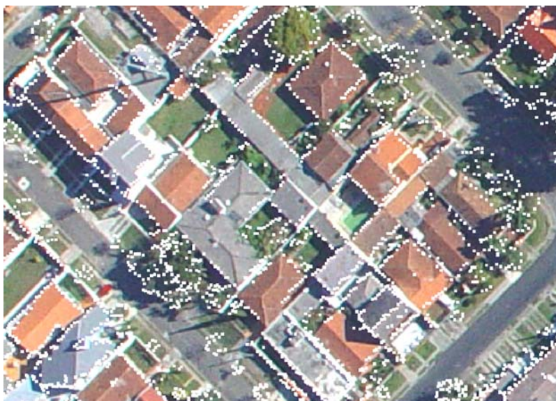
Figura 03 – Mostra os pontos laser scanner selecionados na região de pequenas edificações
