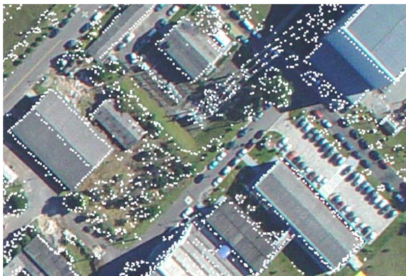
Figura 02 – Mostra os pontos laser scanner selecionados na região de grandes edificações
